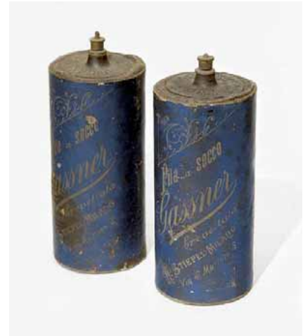
Figura 1, Pila Leclanche Gassner: elettrolito era una pasta di ossido e cloruro di zinco, cloruro di ammonio, e gesso (brevetti tedeschi del 1886 e 1887). Quelle della figura sono contenute in un recipiente di zinco, (primo elettrodo), ricoperto di cartone blu. All'interno, come si vede nell'immagine di dettaglio, è contenuta la pasta ed una barretta di grafite (secondo elettrodo) collegato ad un serrafili sporgente dal coperchio di resina. T di circa 1,44 volt. Misure: Altezza 195 mm, diametro 80 mm, fonte Fondazione Scienza Tecnica https://www.fstfirenze.it/pile-a-secco-leclanche-gassner/
